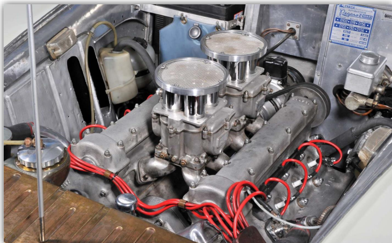
V8:an pressas in i motorrummet så hårt att den måste dras ut för att utföra en ventiljustering.
