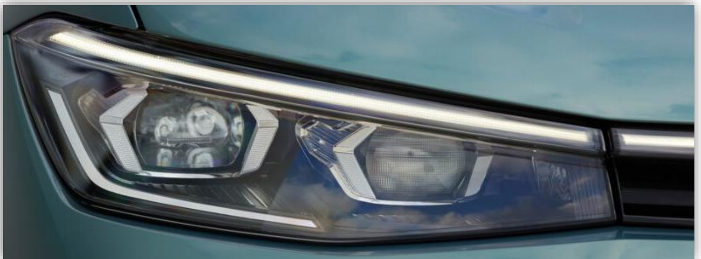
IQ.Light LED Matrix-strålkastare med en räckvidd upp till 500 m finns som tillval.
