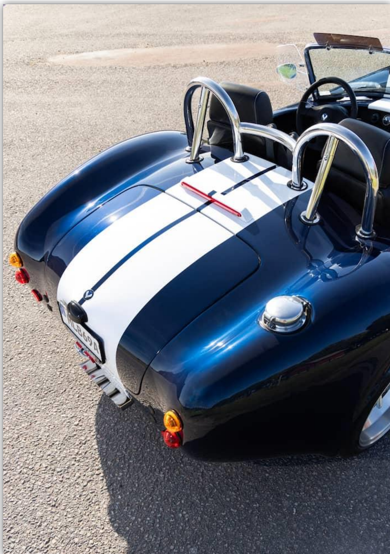
Störtbågarna är inte bara för syns skull. De är tillverkade av rejält gods. Bältena är fästa i bågen.
