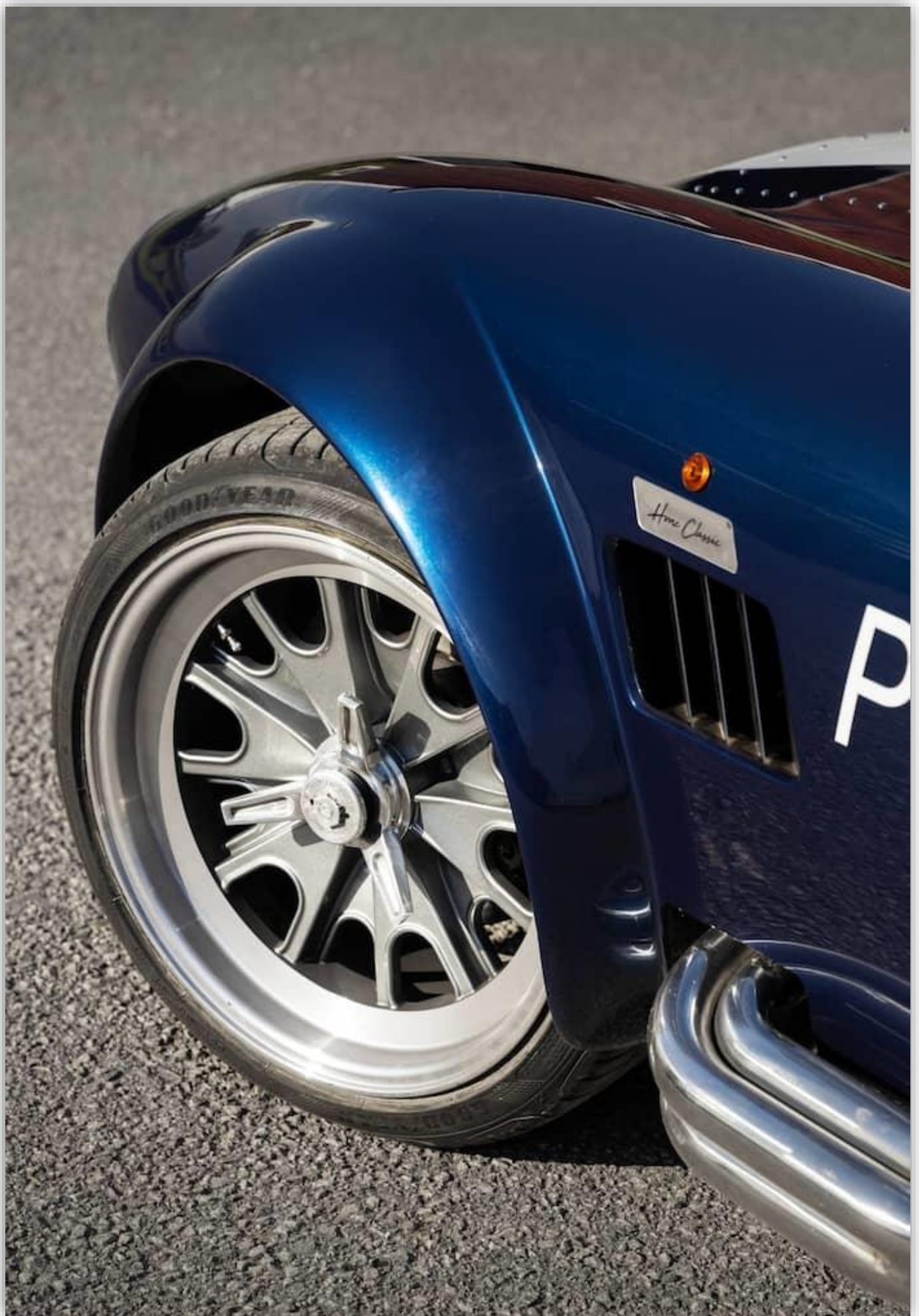
Karossen är av glasfiber, fälgarna har centrumbult som lossas med blyklubba.
