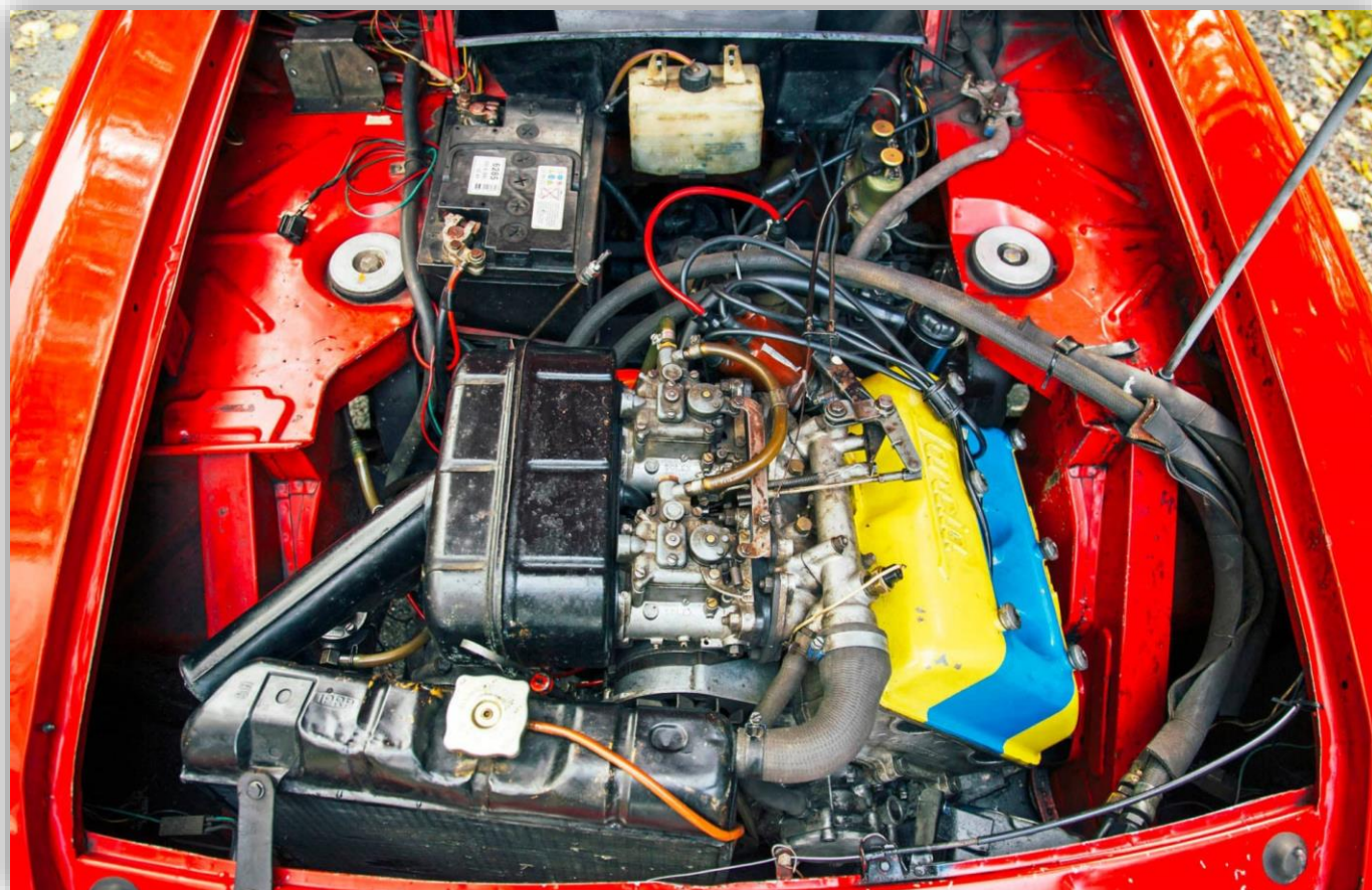
V4-motorn lutar 45 grader i Fulvia. Ventilkåpan är gul på alla HF-versioner. Version "1016" med 132 hästkrafter har ett blått band över kåpan.
