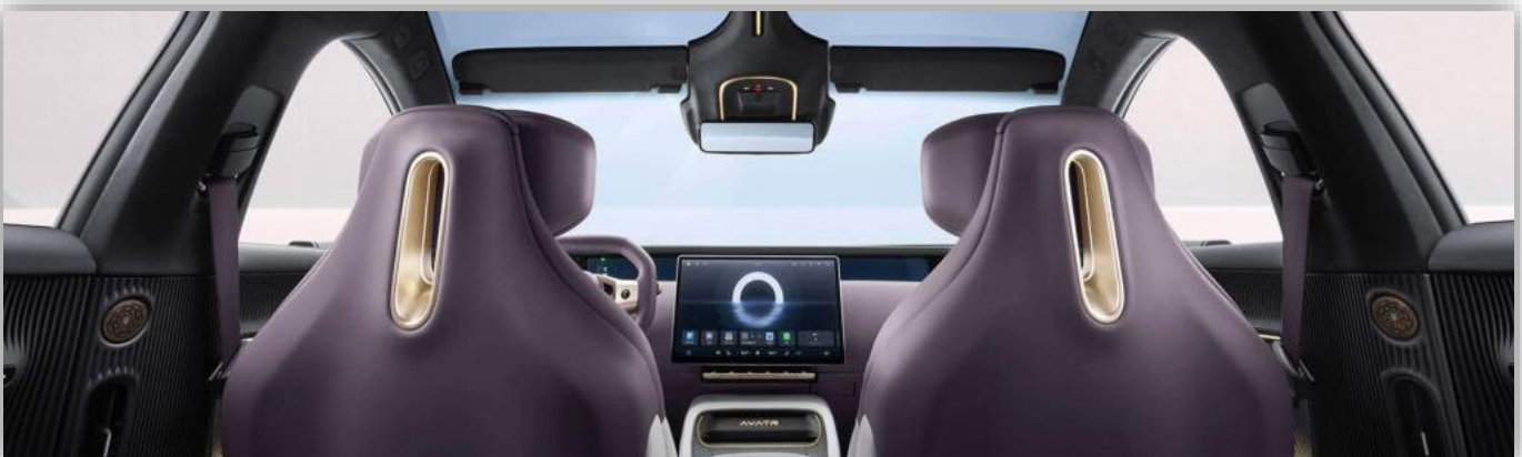
Videobackspeglar både på sidorna och i mitten. Under vindrutan finns en utsträckt lcd-skärm.
