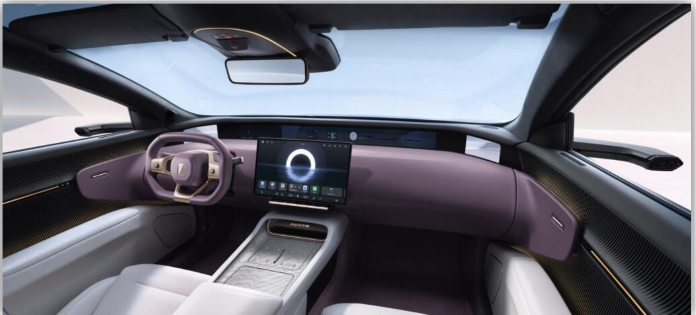
Videobackspeglar både på sidorna och i mitten. Under vindrutan finns en utsträckt lcd-skärm.
