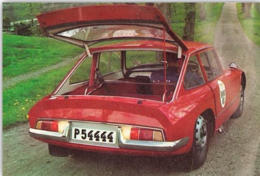
Det tredje spåret av Sonett föll redaktionen på läppen. Plåtkaross och rejäl öppning baktill.
