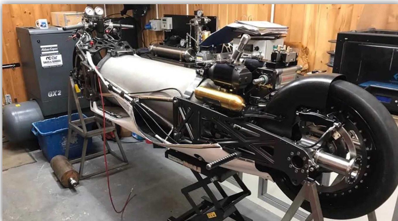
Under karossen finns den enorma ångcylindern.
