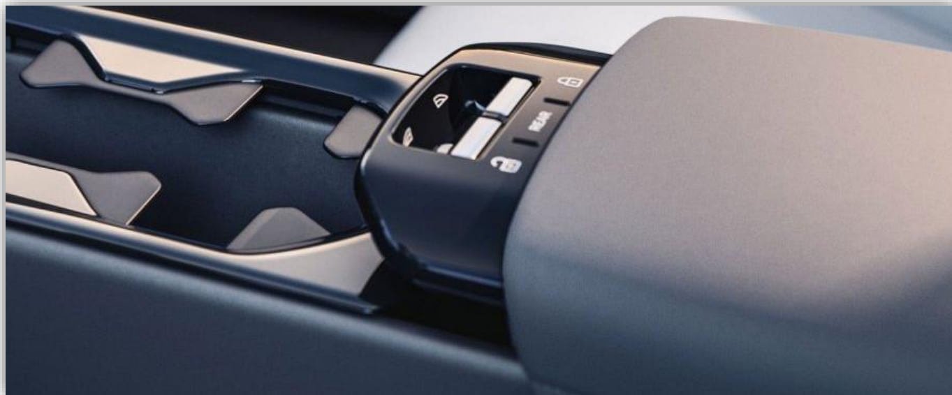
Två vippreglage för elhissarna i stället för fyra.
