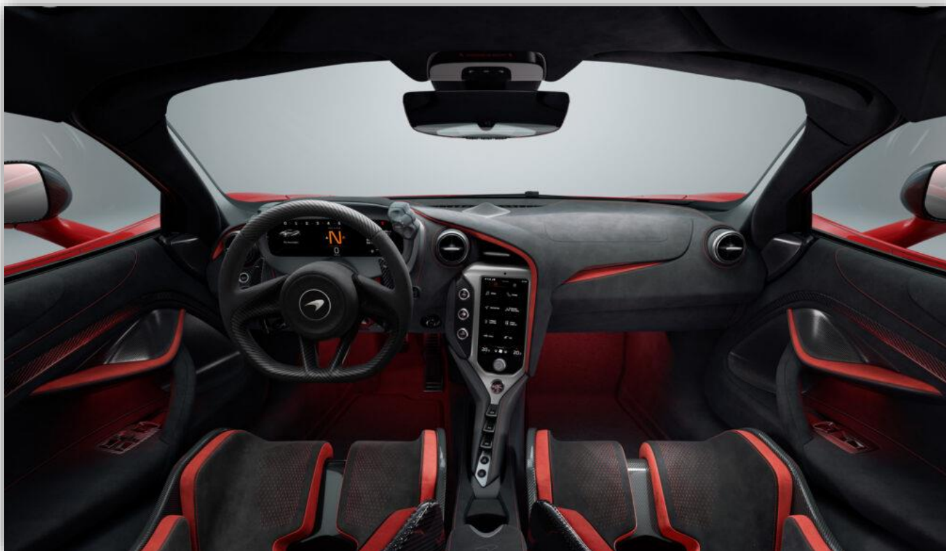
Förarinstrumenteringen sitter på rattstången så att betraktningvinkeln blir bra oavsett hur ratten vinklas.
