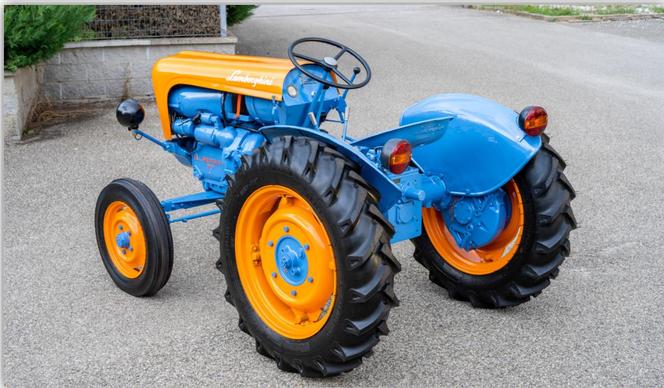
Lamborghinetta har en tvåcylindrig dieselmotor.
