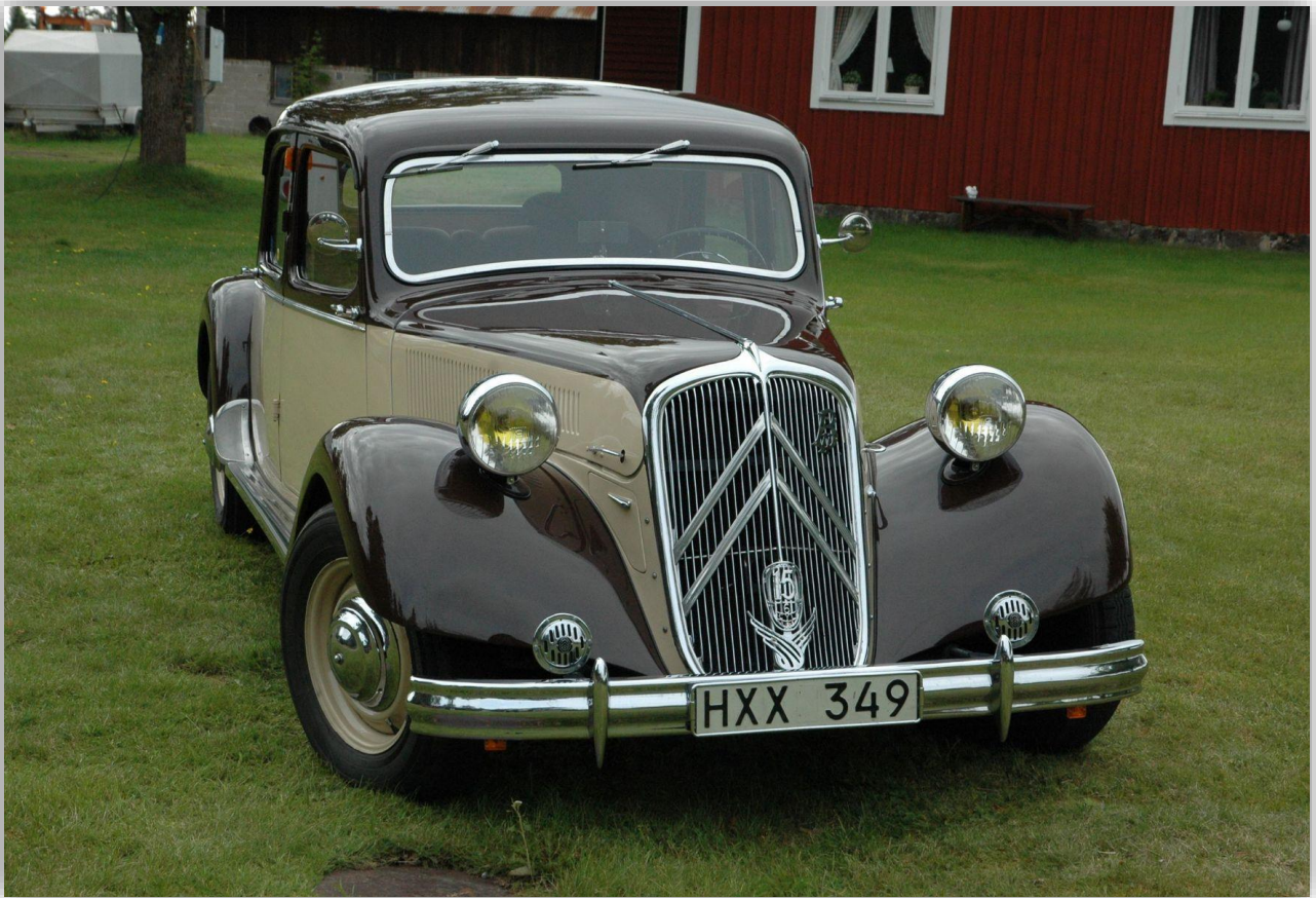
Ändringarna var få under årens lopp. Maj 1946 fick huvsidorna gälar istället för luckor, 1952 flyttade vindrutetorkarna ner till rutans nederkant. PÅ bilden en B15 från 1950.
