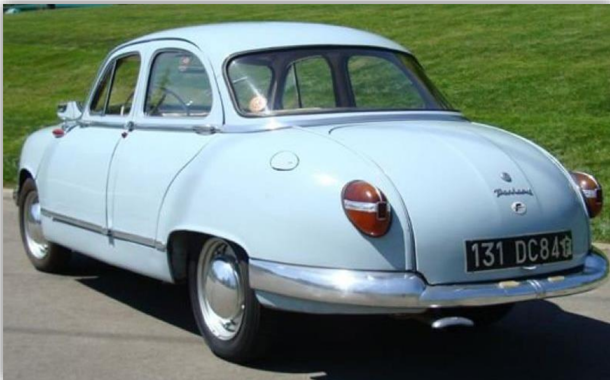
Större baklampor kom till 1957, liksom ändrad instrumentpanel och mindre förändringar i hjulupphängningen.
