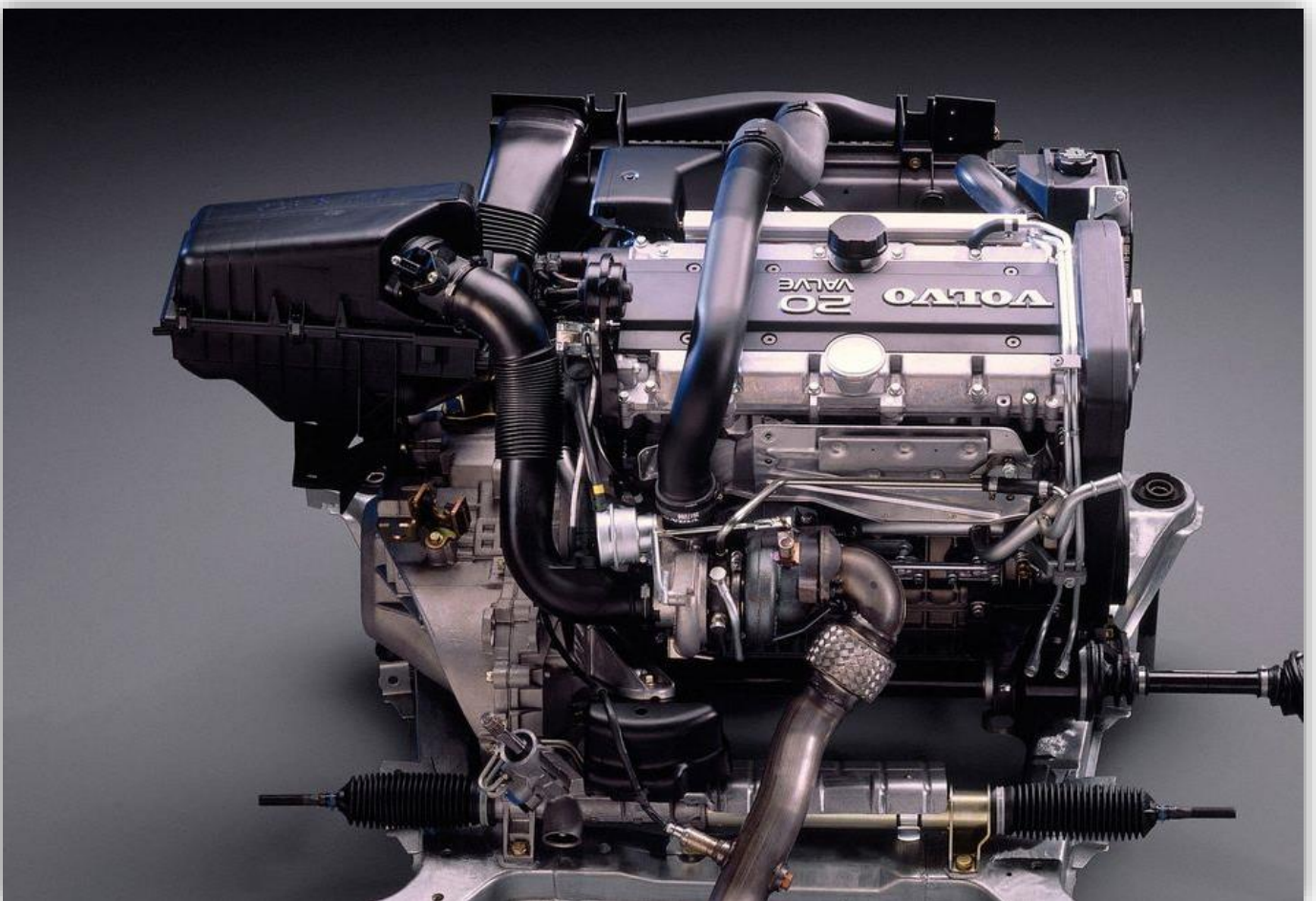
Den femcylindriga motorn tvärmonterades för att ta mindre plats och förfinades under 20 års produktion.
