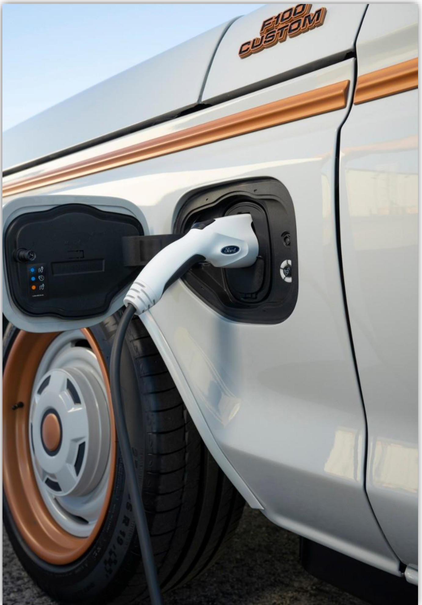
Litiumjonbatteriet laddas med upp till 150 kW.
