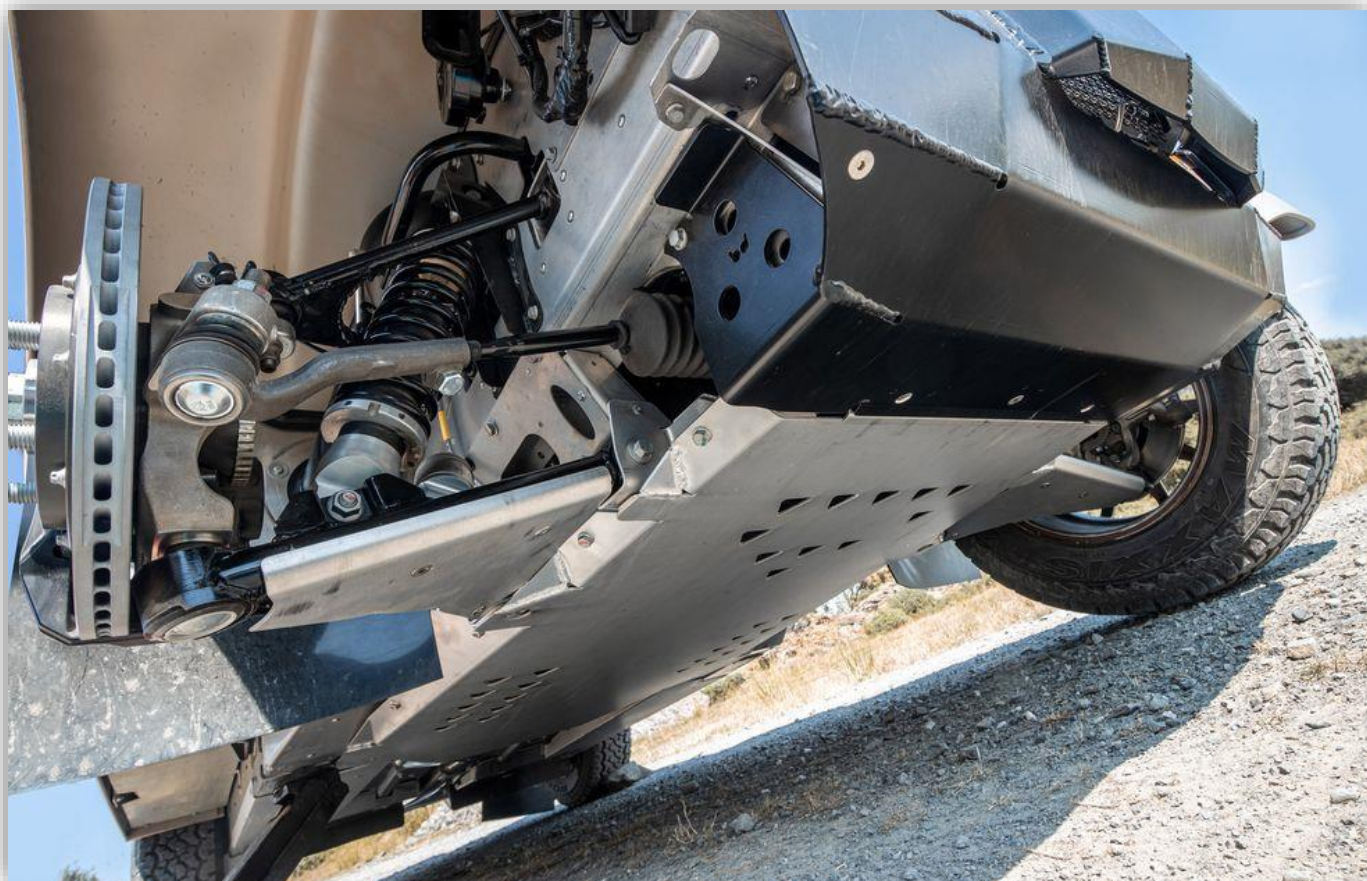
Rally Raids underredsskydd består av fyra skyddsplåtar och ett nytt avgassystem som anpassats för att ge bilen maximal markfrigång.
