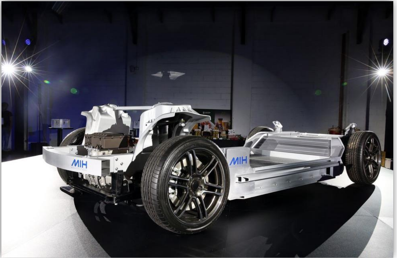
Elbilsplattformen MIH har flera stora gjutna delar i aluminium. "Megacasting"-tekniken är något som även Tesla håller på att ta fram.
