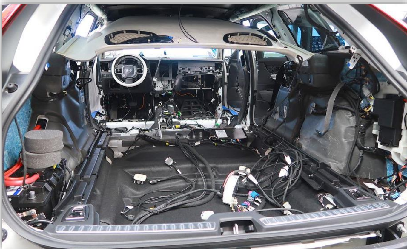
Det är flera många kilo elektronik och annan utrustning som monteras in. Därför har bilarna bland annat förstärka fjädrar och bromsar.
