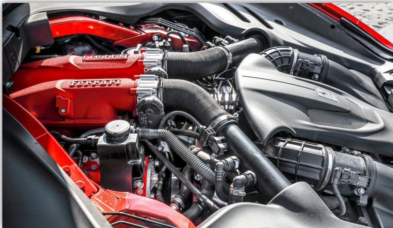
620 hästar i lyxförpackning. Den 3,9 liter stora V8:an med dubbelturbo hör till F154-familjen, precis som alla andra åttacylindriga Ferrarimotorer.
