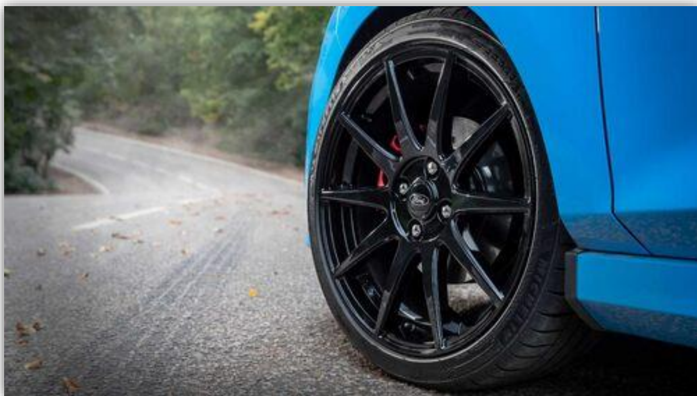
18-tumsfälgar unika för Fiesta ST Edition. Två kilo lättare än standardfälgarna, totalt åtta kilo.
