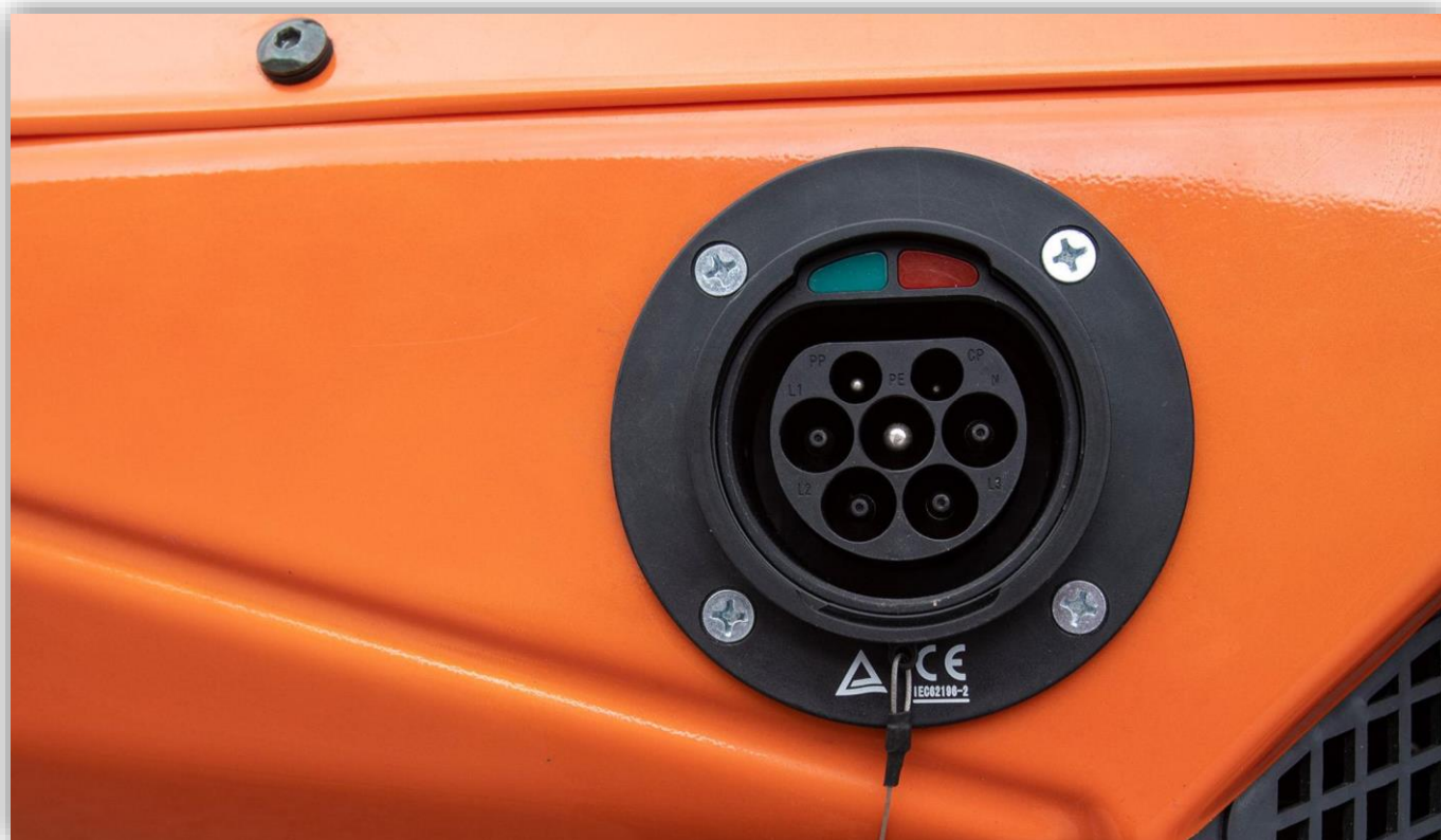
Laddningen sker via Mennekes Typ 2-handske strax bakom passagerarsätet. Batteri på 8,5 kWh.
