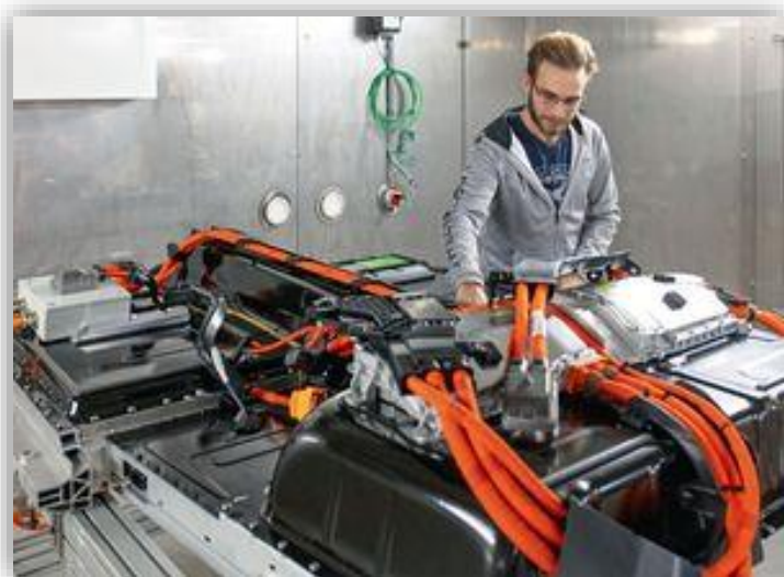
En elektrifierad drivlina blir till. Så här kommer det se ut i alla Volvobilar i framtiden.
