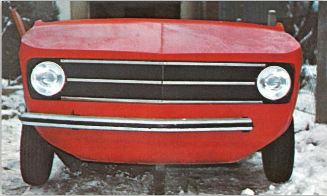
Prototypen, som närmast var en skiss för att studera utrymmen och siktförhållanden, byggdes i plywood och plast.
