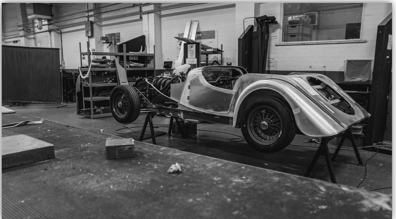
Här syns tydligt de långsgående bladfjädrarna på stålramen. Chassit på bilden är det absoluta sista tillverkade, en era som inleddes 1936 är därmed över.
