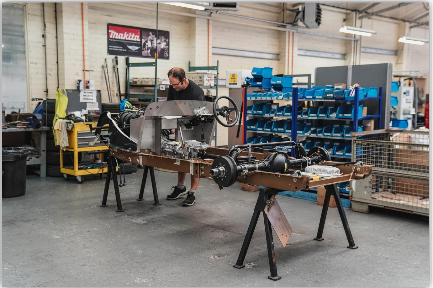
Här syns tydligt de långsgående bladfjädrarna på stålramen. Chassit på bilden är det absoluta sista tillverkade, en era som inleddes 1936 är därmed över.
