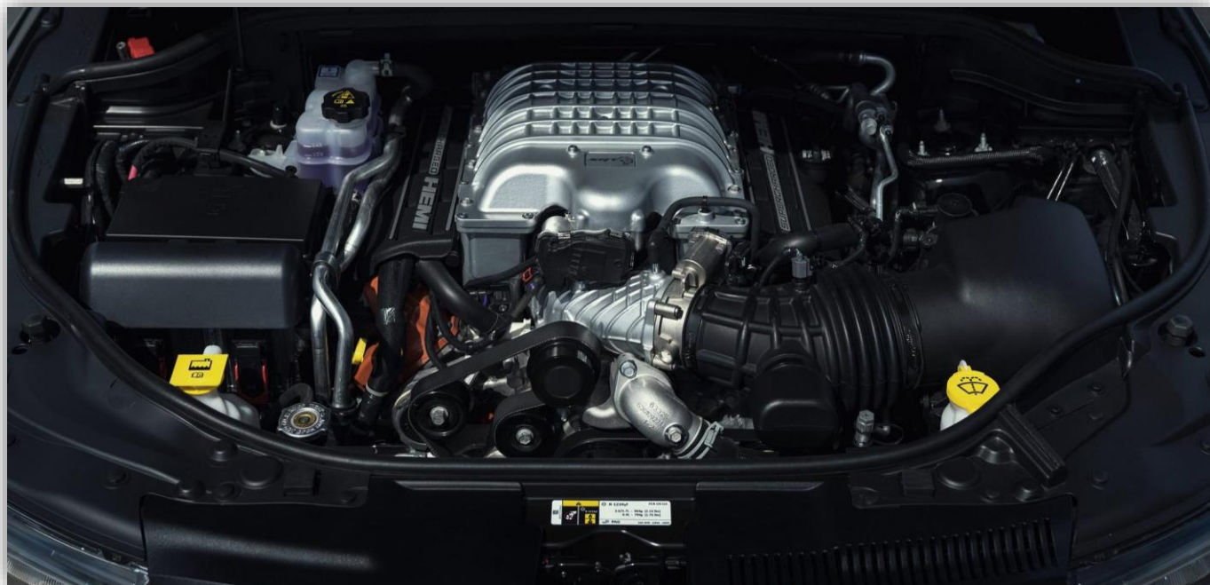
Hellcat-motorn på 6,2 liter och 720 hästkrafter. Kompressormatad.
