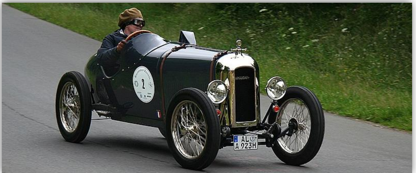
Amilcar CS mit Duval-Karosserie, 4-Zyl.-Motor, 985 cm 3 , 23 PS,
