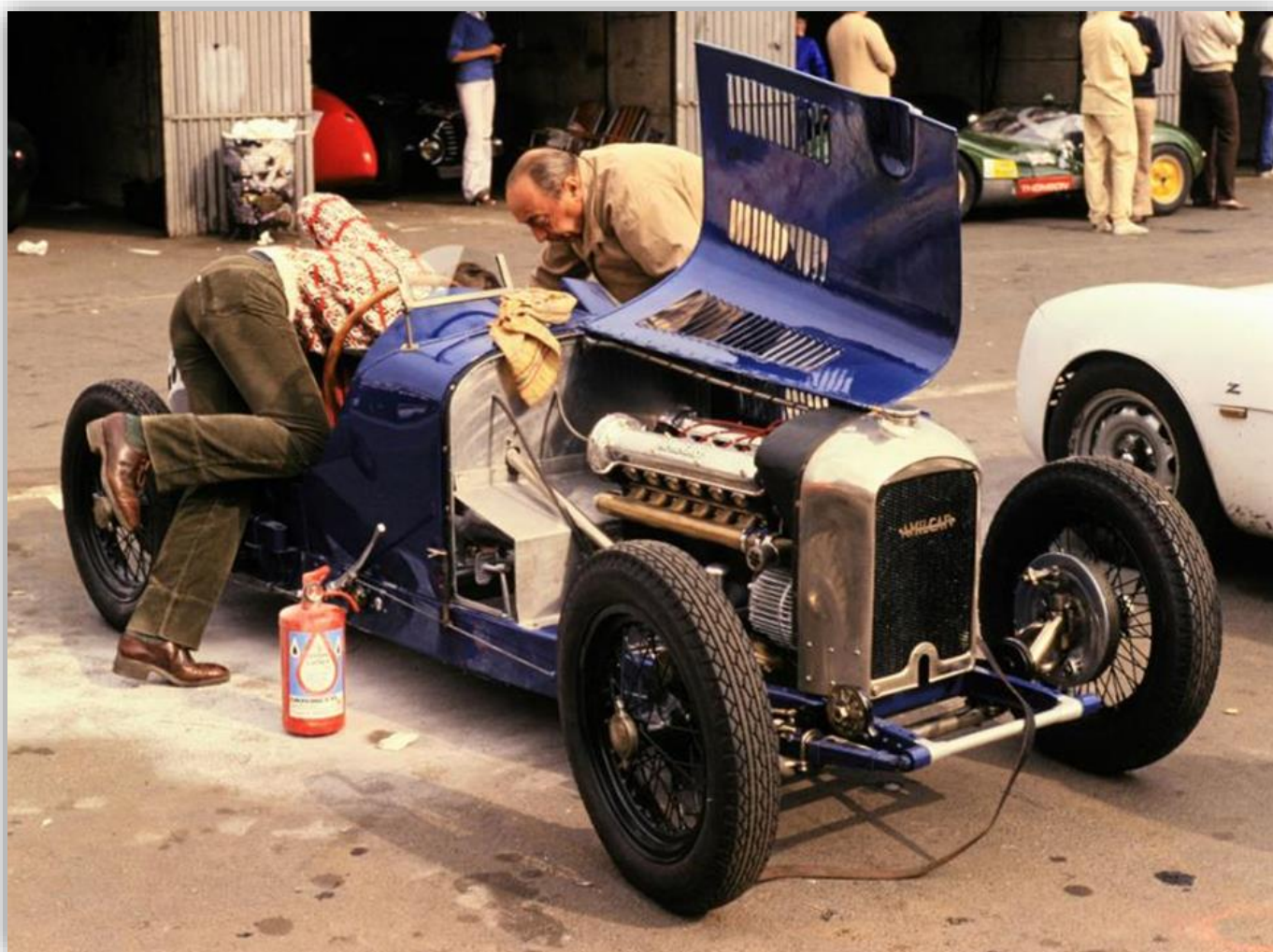
Dubbla överliggande kamaxlar på den raka sexan karakteriserade C6-modellen. Det fixas febrilt i depån på Nürburgring.
