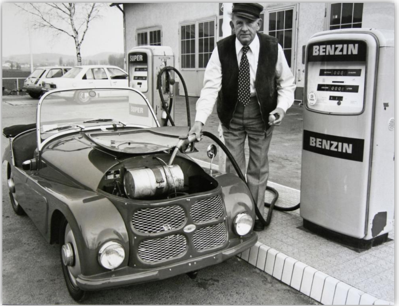
I en liten kanister livsfarligt placerad rakt ovanför motorn håller man bensin och hoppas på det bästa. Max tre deciliter går åt per mil.
