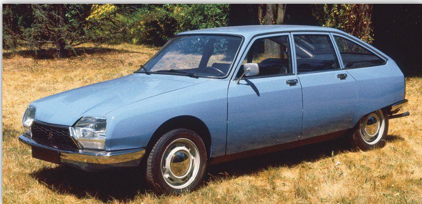
GS dök upp 1970. Drivs av en 1 015 cc luftkyld platt-fyra som kör framhjulen, den innehöll aerodynamisk styling och hydropneumatisk fjädring.
