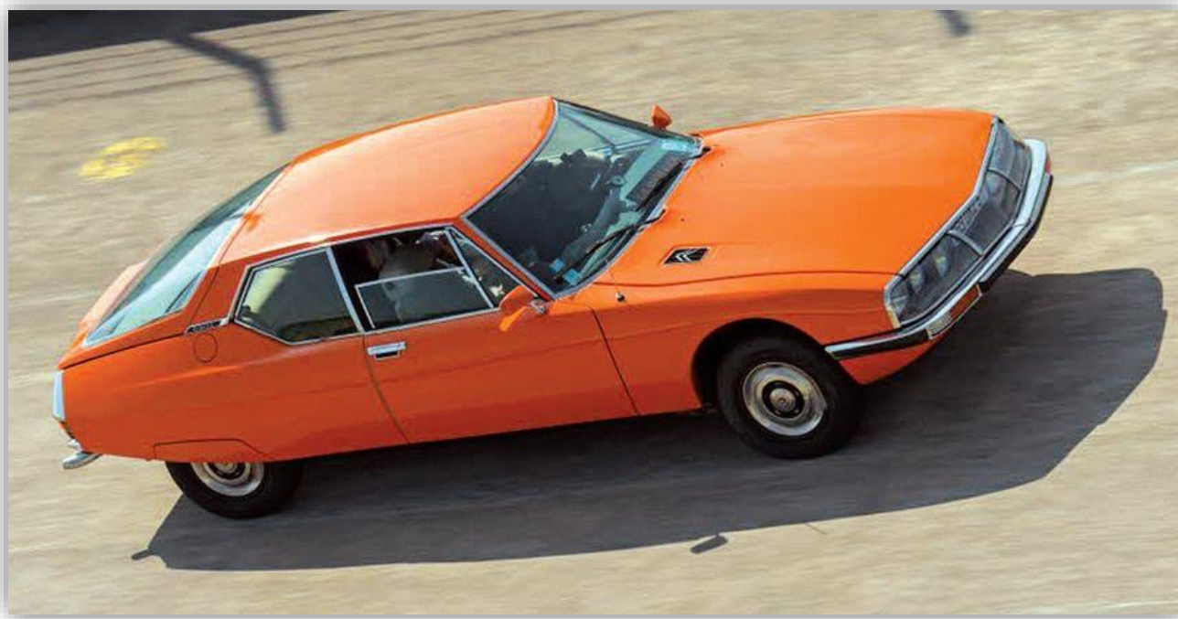
SM innehöll DIRAVI, ett fulldrivet styrsystem med hastighetsvariabel assistans och driven centrering. Coupén kunde toppa 130 mph.
