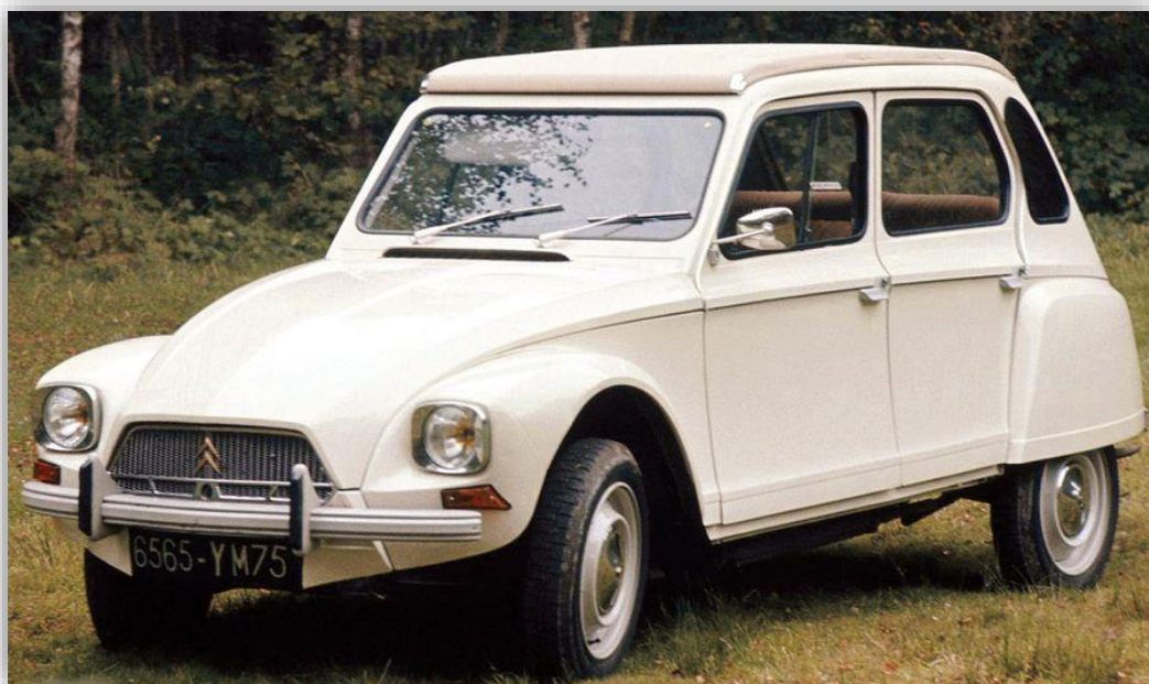
En uppdaterad version av 2CV, Dyane drevs av en 425-cc platt-tvillingmotor. Mer än 1,4 miljoner av de fyra dörrars luckorna byggdes mellan 1967 och 1983.
