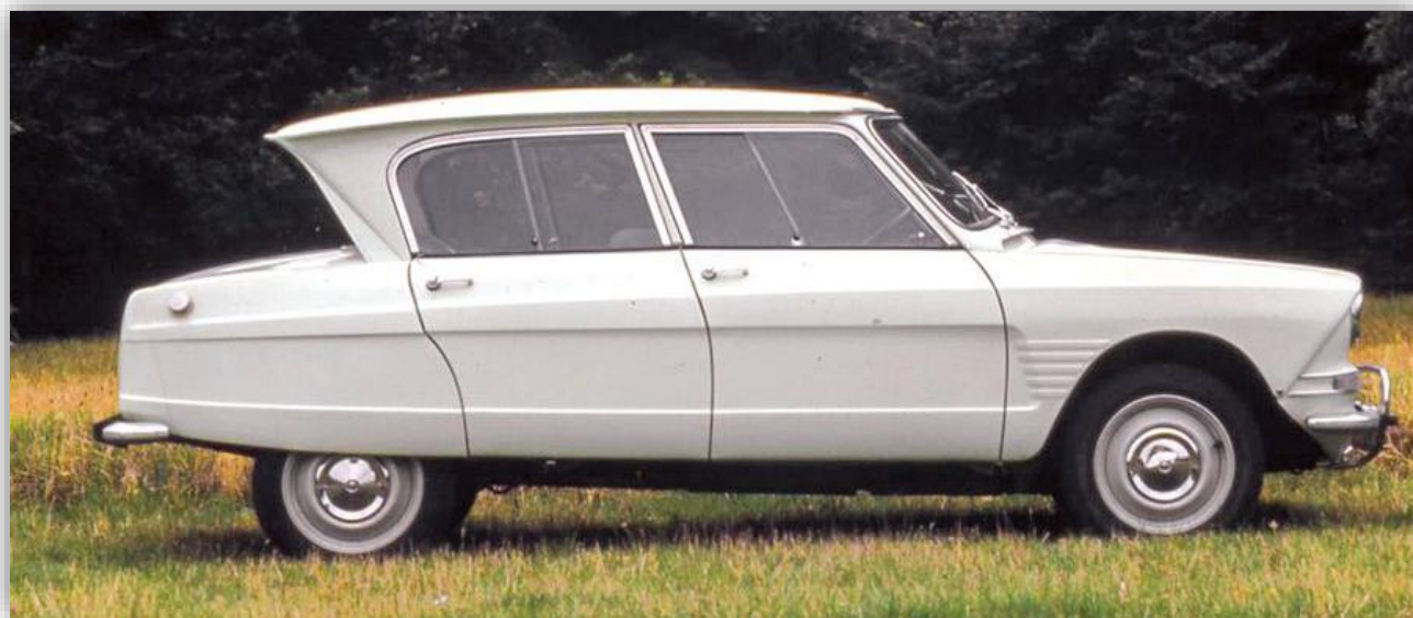
Drivs av en luftkyld tvilling på 602 cm och Ami 6 var tänkt att fylla det stora marknadsgapet mellan 2CV, DS och ID. Det producerades mellan 1961 och 1971.
