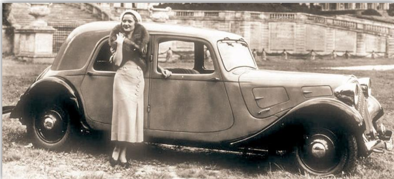
Traction Avant 11 A lanserades 1935, driven av den 1 911 cc fyrcylindern som användes i 7 Sport-modellen. Stammen nås inifrån bilen.
