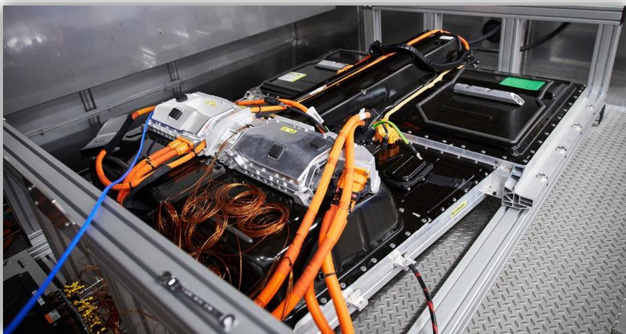
Batteriet från XC40 Recharge inne i ett testskåp.
