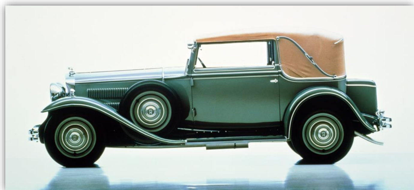
Typ 420 tillverkades 1931–32 med rak åtta på 4,5 liter. En försäljningssuccé mätt med den tidens Horch-mått: 256 tillverkade.
