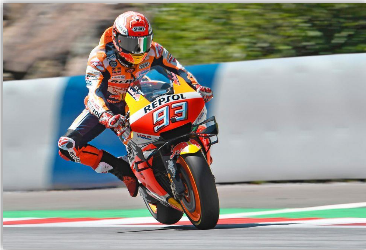
Små, aerodynamiska winglets pryder Marc Marquez Honda. Notera bakhjulet som "hänger i luften" under hård inbromsning.
