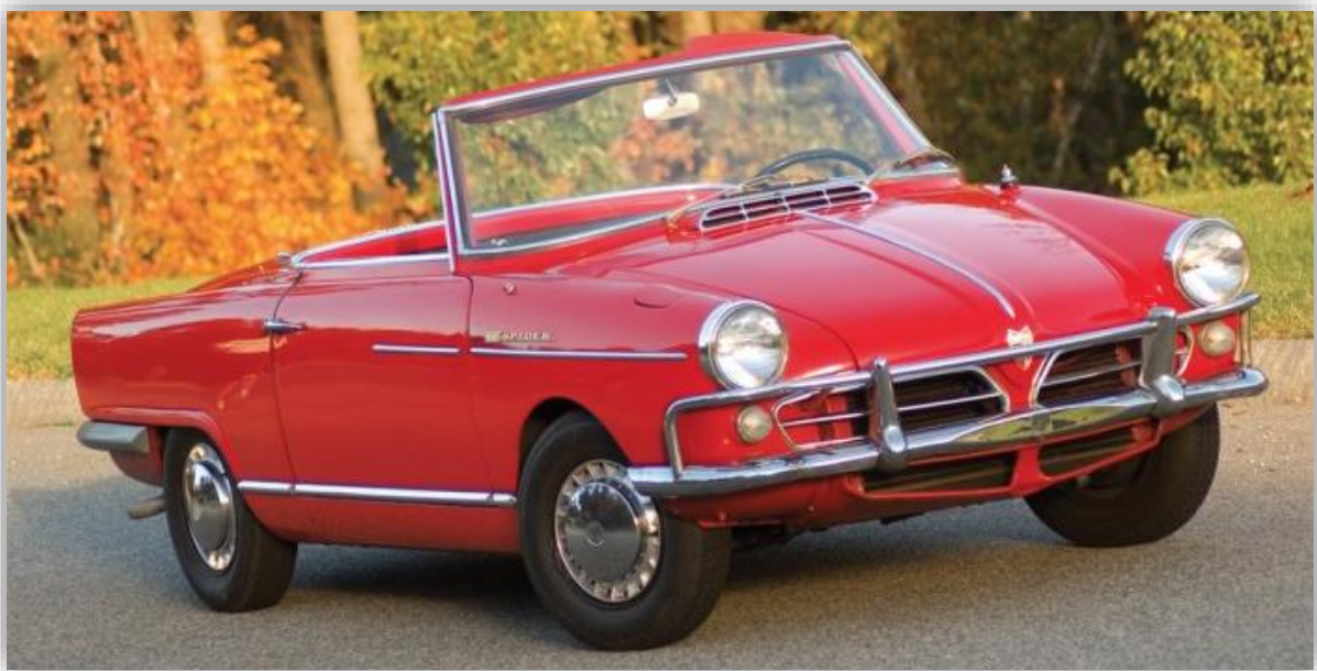
NSU Spider var världens första seriebyggda bil med Kreiskolben-/Wankel-motor.
