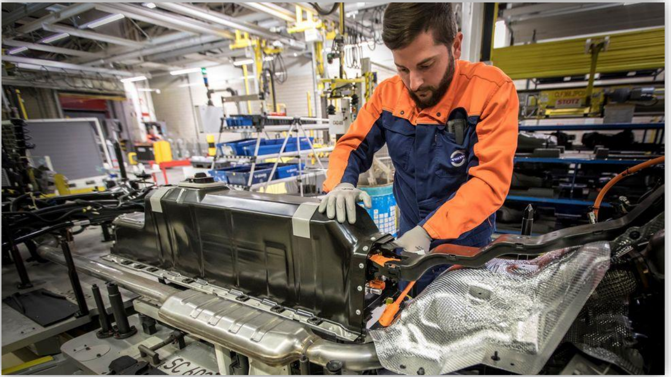
Montering av batterier i Volvos fabrik i Gent.
