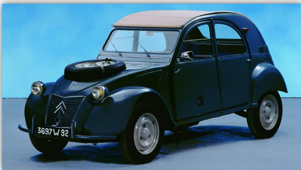
2CV 4x4 Sahara 1960–71 (med dubbla motorer, en fram och en bak).
