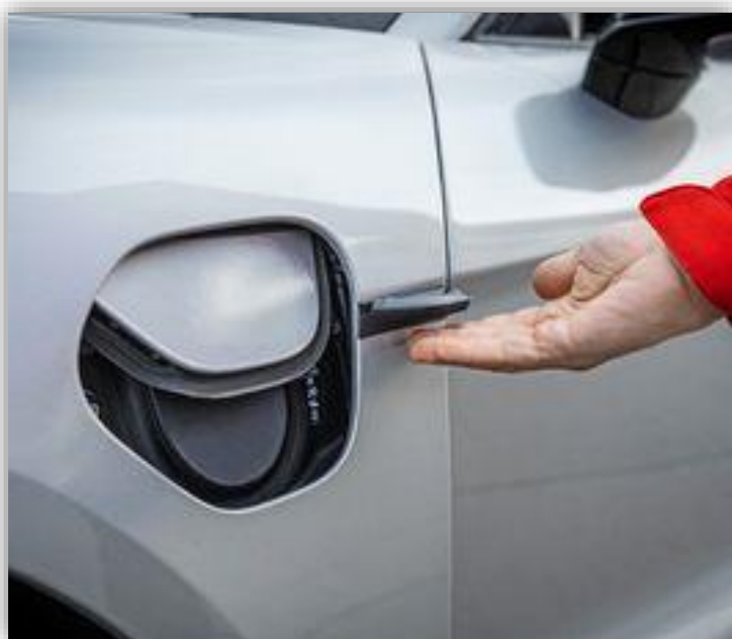
Laddlucka med sensor.
