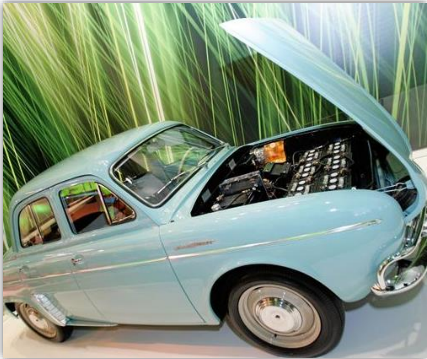
En Renault från 1959 utrustad med tolv stycken 6-voltsbatterier.
