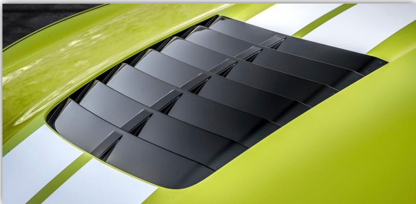
Motorns överskottsvärme försvinner genom ett jättelikt galler i huven.
