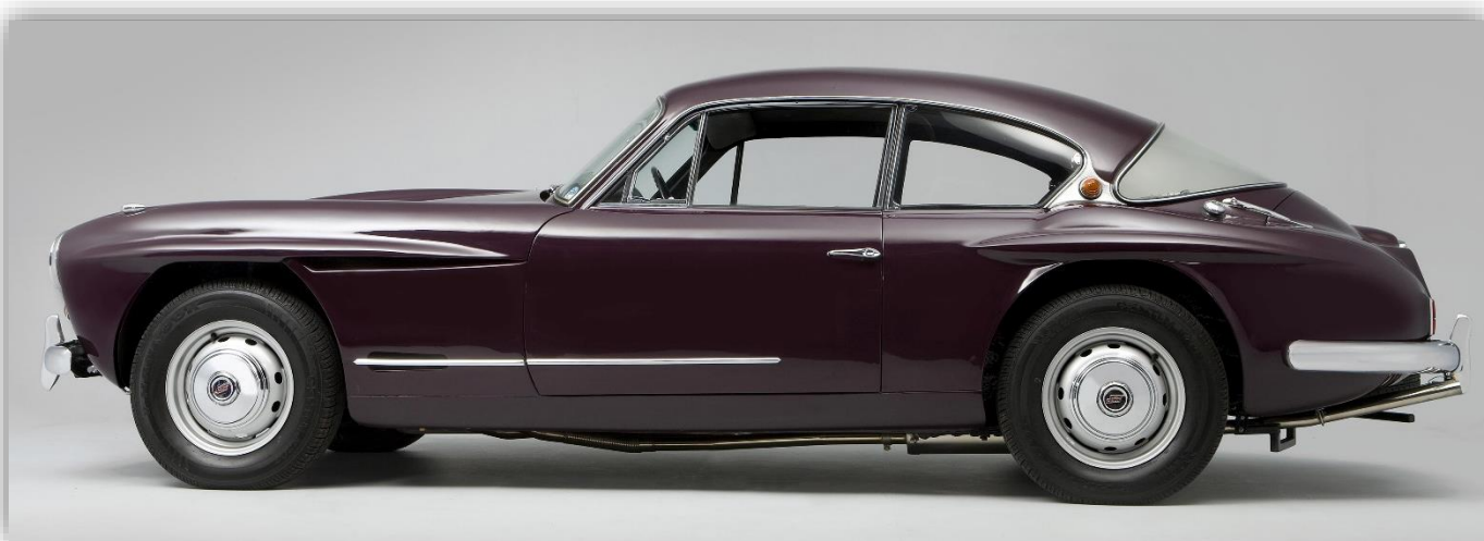
541 R hade Austins sexcylindriga 150-hästarmotor, glasfiberkaross och för sin tid mycket bra prestanda. Notera de 300 SL-liknande utsmyckningarna ovanför hjulhusen.
