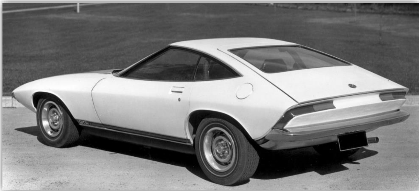
Kofångare, väl tilltagna dörrar och en stor baklucka som lyfte högt. Man tänkte produktionsbil hela vägen genom projekt GTR-X
