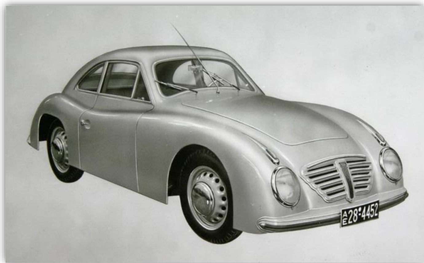
Nästan en Porsche! Goliath GP 700 Sport hade tvåtakts insprutningsmotor och byggdes i mycket begränsat antal. Det vackra stålkarosseriet byggdes av firma Rometsch i Berlin-Halensee, som också byggde VW-baserade bilar under eget namn.
