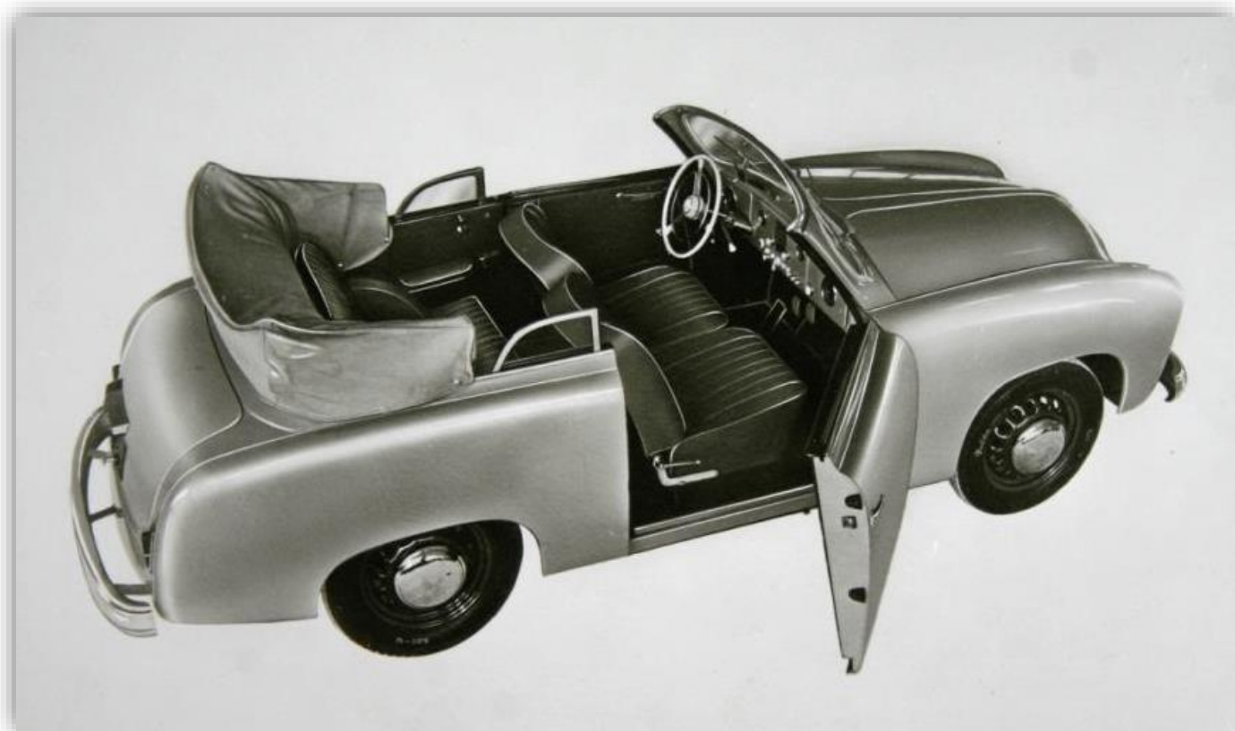
GP 700 Luxus-Cabriolet kallade tillverkaren den här till synes så solida vagn. Pontonkaross med platta sidor, lätt välvd vindruta.
