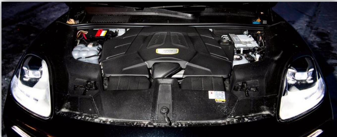
En V6-motor från systemmärket Audi på tre liter och 340 hästkrafter. Med elmotorns hjälp blir systemeffekten 462 hästkrafter.
