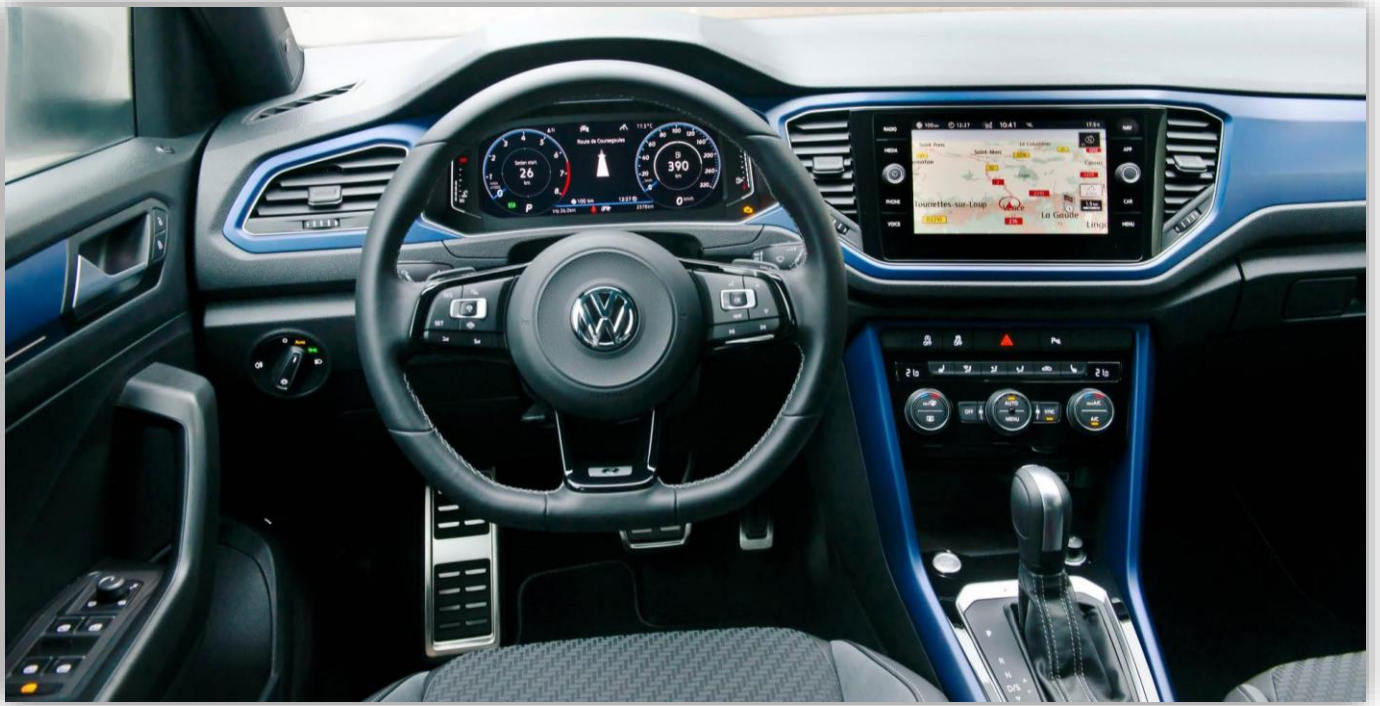
T-Roc R har andra generationen digitala instrument med inställningsbar layout. Platt ratt nedtill.
